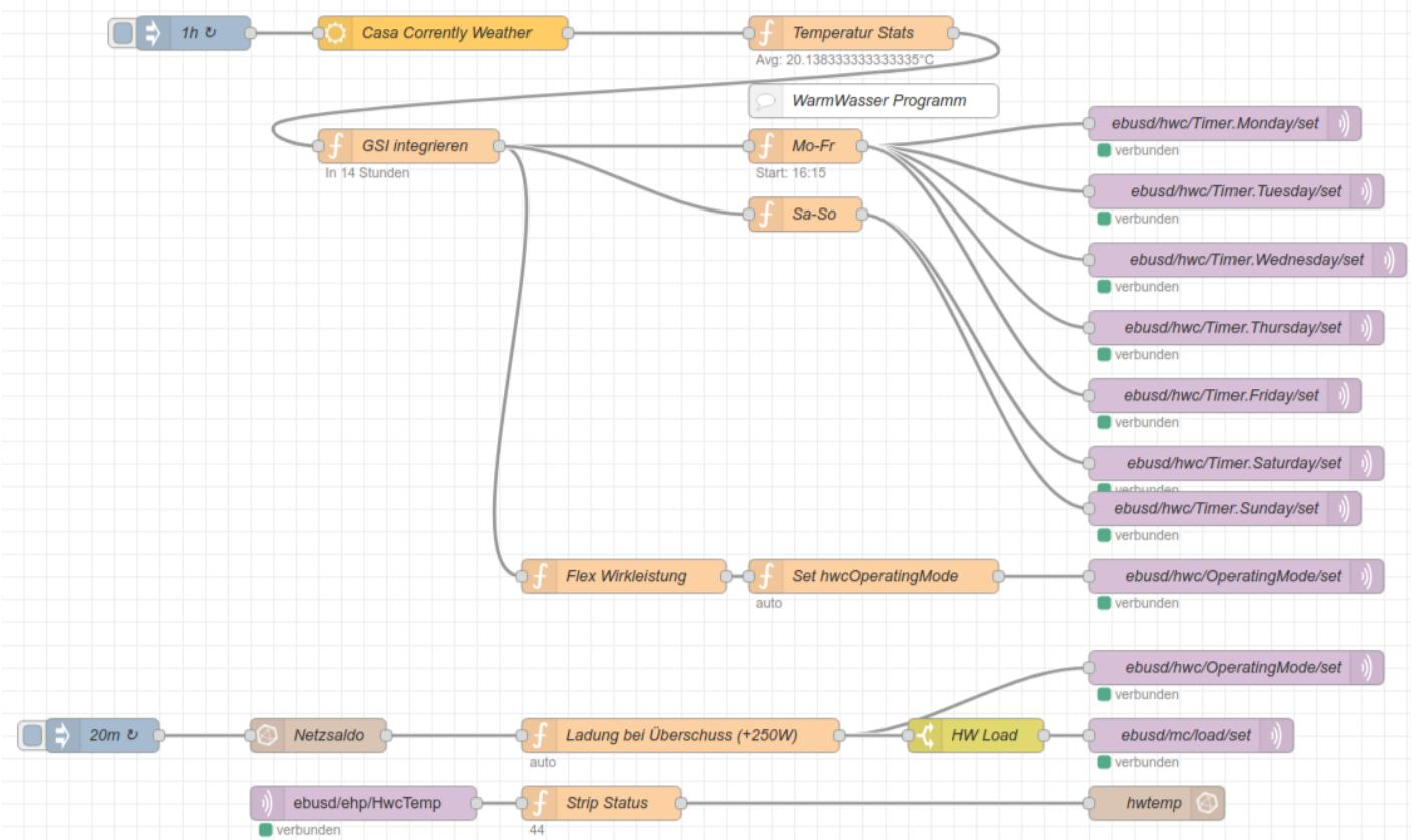
In diesem Beispiel kommt eine Vaillant Wärmepumpe zum Einsatz, deren Warmwasserzubereitung über Casa Corrently optimiert wird. Zunächst wird der kombinierte GrünstromIndex (`eXgsi`) abgefragt, um dann die beste Zeit für die Warmwasserzubereitung zu definieren und im Programm (Timer) des Gerätes zu hinterlegen.
